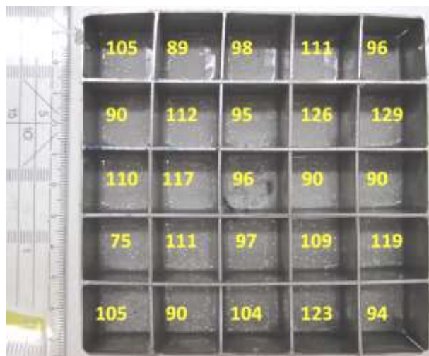
Abb. 3: Beispielansicht einer Teilkammer mit Partikeln (links) und des gesamten Flächenteilers nach kompletter Auszählung.
